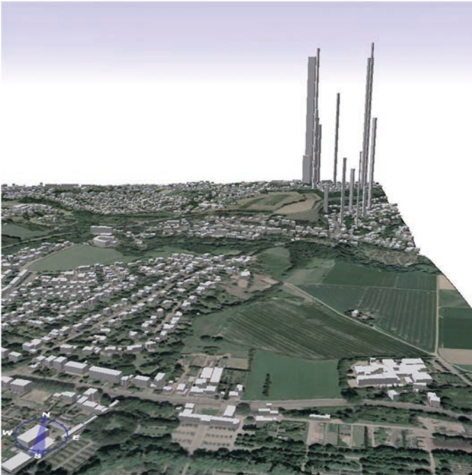
Abb. 2: Fehlerhafte Laserscanningdaten (Quelle: Bezirksregierung Köln)
